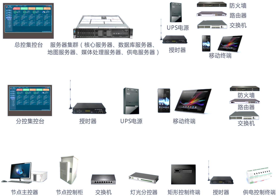
图 5-6 照明控制层级架构
